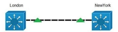
London(config)#interface range fa0/1-2 London(config-if-range)#switchp trunk encapsulation dot1q London(config-if-range)#switchp mode trunk London(config-if-range)#channel-group 1 mode active London(config-if-range)#end London#
